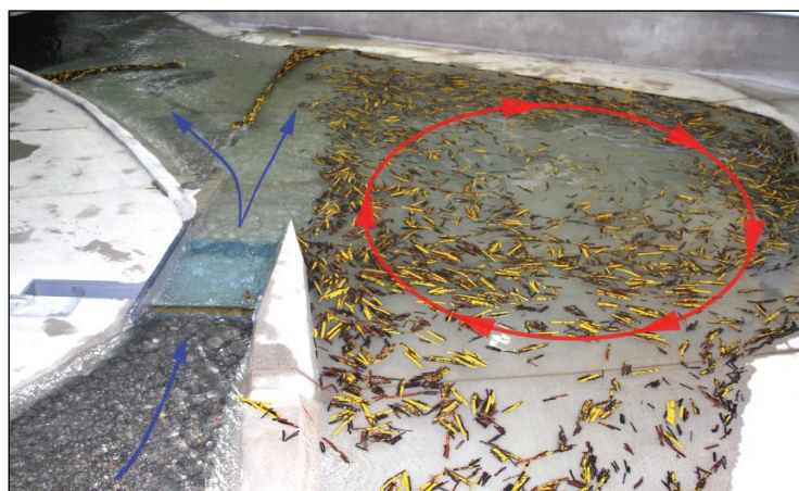
Prove su modello idraulico per la ritenzione del legname presso il VAW ETH Zurigo
