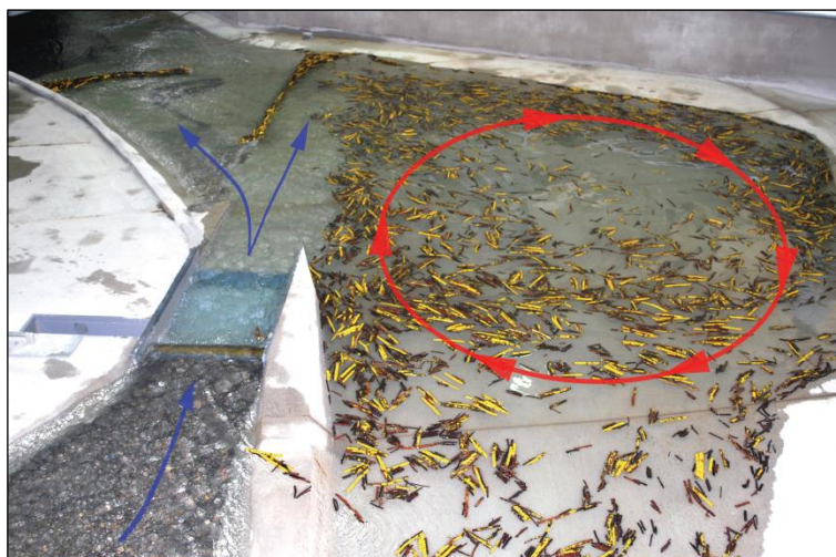
Hydraulische Modellversuche für Holzrückhalt an der VAW ETH Zürich
