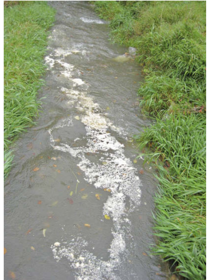
Abb. 12: Situation vor (oben links) und zwei Monate nach dem Einbau von Lenkbuhnen aus Blocksteinen (unten links); visualisierte Oberflächenströmung bei erhöhtem Abfluss im Oktober 2008 (rechts). Blick in Fließrichtung [1]
