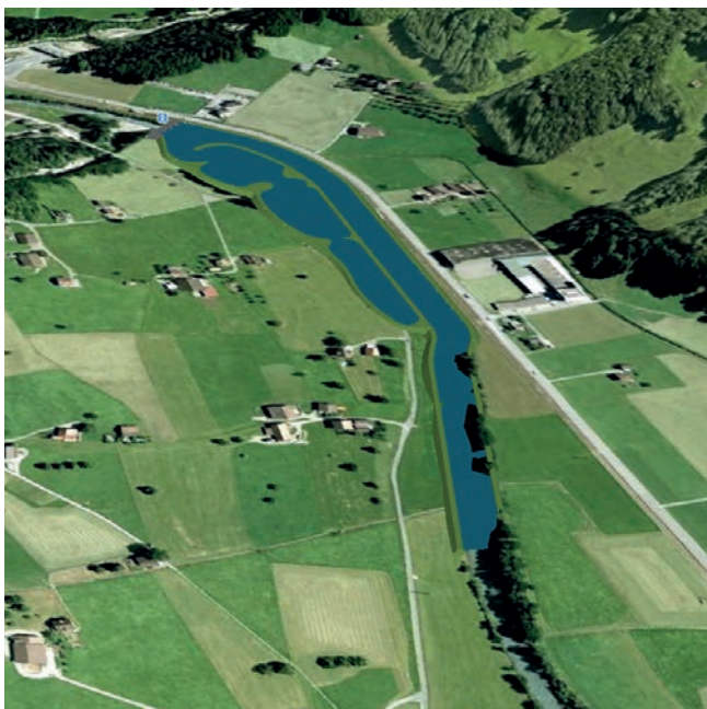
KW Engelbergeraa Dallenwil, Visualisierung Mehrzweckanlage mit KW-Nutzung, Schwall-/Sunkdämpfung & HW-Schutz. (Mit freundlicher Genehmigung von E. Dufey)
